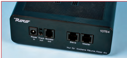
An der Rückseite befinden sich die Anschlüsse für den Trafo, das Gleis, weitere Booster und die Master- und Slave-„Mäuse“. Der reine Booster (Art.-Nr. 10765) hat neben Trafoein- und Gleis Ausgang lediglich die zwei Buchsen für Booster „in“ und „out“.
